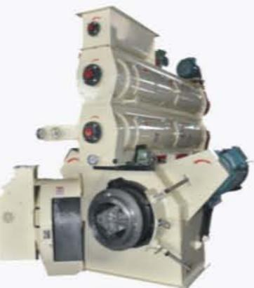
PM型环模制粒机是引进德国专有技术生产的颗粒饲料压制机。本机具有优质环模、压辊、工艺先进。传动系统采用双电机三角带传动，占地少、受力均匀、结构简单、转动平稳、操作维护方便。还可变换电机、环模，适应不同的生产能力和不同规格的需要，取得理想的技术和经济效益。
