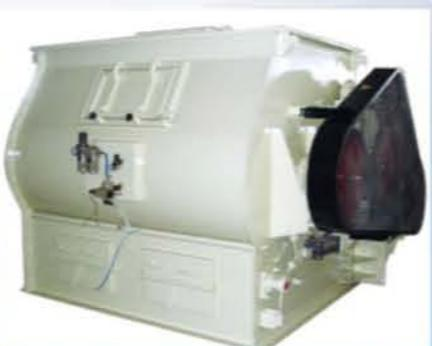
桨叶高效混合机是一种经典机型，适用于预混料、畜禽料、水产饲料、添加剂、食品、化工、医药等行业粉状物料的混合。采用单轴及双轴运转搅拌，高效混合，动作柔和，混合均匀度高，混合时间短。底部为全长双开门结构，不漏料，卸料迅速、无残留。设置回风管，粉尘无泄漏，充分满足环保要求。同时机内配有油脂添加管路，可添加多种液体（如：水、油脂等）。该机是一种低速、高效、柔和、均匀、节能的理想混合设备。
