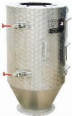
TCXT系列永磁筒主要用于分离原料中的磁性金属夹杂物，适用于各种规模的饲料厂、粮油加工厂，以及溶剂、酿造厂等。磁芯采用永磁材料制成，无需动力，强力除铁，磁场强度 $\geq 3000\text{GS}$ ，除铁效率 $\geq 98\%$ ，结构合理，占地面积小，综合性能先进。
