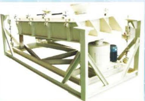
SFJH系列平面回转分级筛主要用于饲料、粮食、化工、食品厂等多种行业的物料的筛选和分级，特别适用于颗粒饲料的分级筛选。采用筛体运动的特殊平衡方式，尾部弹性支撑，有效辅助振动筛体各个方向的惯性力得到适当平衡，确保工作中振动小、噪音低。筛面处于周期性的椭圆运动及往复直线运动综合状态，并配设筛面清理装置，因而筛分效率高、动耗小。此外，该机安装灵活、换筛方便，便于维护保养。有两层筛、三层筛和两层筛双进料可供选择(根据需要定制)。
