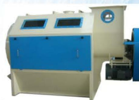
SCQZ系列粉料清理筛适用粮食加工厂、配合饲料厂及其他行业粉状物料的清理，可有效地分离出混杂在粉状物料中的秸秆、麻线、土块、石头等各种杂物。该机具有筛粉效率高、运转平稳可靠、结构紧凑、空间占用小、安装维修方便、更换锥形筛筒容易等优点。能有效地保证后道加工设备和输送设备的正常工作。
