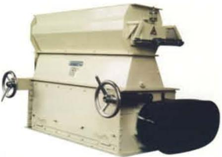
SSLG系列辊式破碎机广泛用于畜禽、水产颗粒饲料的破碎，利用双辊不同齿形差速原理实现1.2~6.0mm颗粒料的破碎，成品率高，含粉率低。可根据用户不同破碎粒度和粒形的需求选配不同齿形的破碎辊，采用辊式布料器可使处物料在破碎辊全宽度方向均匀连续喂入，最大程度上保障破碎料的均匀性，延长破碎辊的使用寿命。本产品噪音低，效率高，占地面积小，传动机构先进，配有旁流装置，并配备取样孔。
