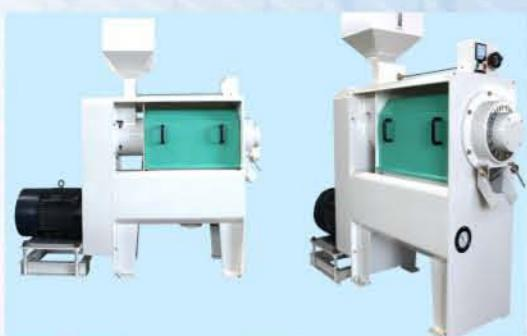
**砂辊碾米机、小米（高粱米）碾皮机** 采用轴端双向进风，辅助以轴承位、进出料口多点进风技术，碾白温升低，排糠性能更好。优化的参数设计，采用加长型砂辊，碾白更均匀，加工精度好，碎米少、整精米率高。采用全新组合式筛架设计，有效降低爆筛率，米筛更换快速便捷。机电一体化控制设计，操作简洁、维修方便。传动系统后置，占地面积少，安装方便。
