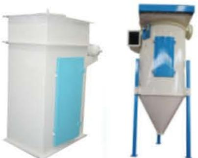
TBML脉冲布袋除尘器是用于将含粉尘空气中的粉尘分离，通过圆型外壳达到离心积尘作用，使含尘空气经过滤介质取得高的纯洁度（即净化），以满足现代化环境保护要求。该设备广泛用于粮油、饲料、食品、冶金、化工、医药、建材等行业的气尘分离和粉尘回收。本设备具有结构紧凑合理，占地面积小，除尘效率高等特点。采用针刺尼龙布袋，特殊的旋转抱箍拆卸布袋结构，拆卸快捷、维护简单方便。
