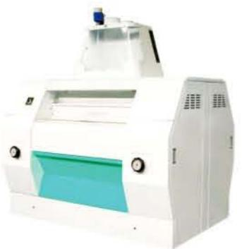
**Hx系列气动面粉机** 该系列面粉机为全封闭、复式结构设计，表面静电喷涂，造型美观大方，外观豪华；采用全气压自动控制，即可单机控制，也可远程集中控制，还可电脑全自动控制，变频喂料控制方便快捷，自动化程度高；磨心内设有负压吸风装置，可改善喂料状况，降低磨辊与物料温度；该系列磨粉机是面粉厂研磨制粉的主要设备，以加工小麦为主，也可加工玉米或者其他杂粮，适用于大、中型玉米、杂粮、小麦联产成套设备配套。
