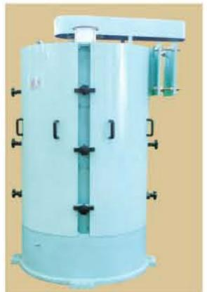
**DTP系列玉米搓揉脱胚机** 该机采用刚性碰撞和柔性搓揉，使玉米粒分成6-8瓣，粒型相对方形且相对整齐，保证了胚芽的完整性；产量大、出粉少，可大幅提高成品率，保证脱胚和提胚获得最佳的提取率和纯度，是玉米精深加工企业、酒类加工企业、玉米油脂企业、饲料加工企业进行玉米脱胚的理想设备。
