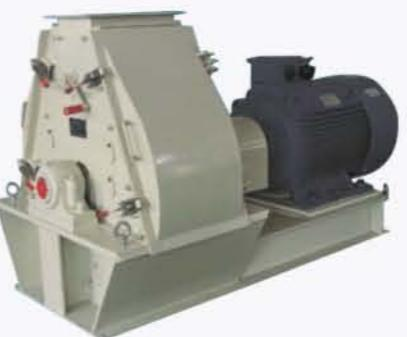
HM水滴型系列粉碎机适用于粉碎各种颗粒状饲料原料，如玉米、高粱、麦类、豆类、破碎后的饼类及其它物料。该机粉碎室采用水滴形结构，在滴形结构下部设有再粉碎室，使粉碎的效率大为提高；锤片的工作面敷焊一层硬质材料，或采用整体渗碳淬硬处理，延长了使用的寿命。本机功率大，产量高，运转平稳，操作维修方便，是各饲料生产及粮食加工厂家的理想设备。
