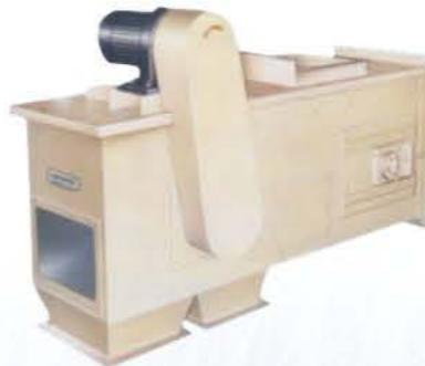
SWLJ带式磁选喂料器是一种新型的强力除铁、喂料组合装置，适用于粉碎机或其它任何需要磁选去铁防护设备的连续喂料系统。该机具有结构合理、性能可靠、输送能力大、喂料均匀、易于控制、除铁效率高、安装与维护方便等特点。采用强力永磁头轮，能自动连续清除物料中的含铁杂质，可提供全宽度无脉动连续均匀喂料，可通过手动粗调和变频调速机构来实现喂料量的调整，确保粉碎机一直处于最佳工作状态。
