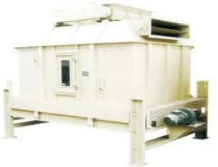
SKLN型逆流立式冷却器通过空气流沿竖直方向逆向通过物料流，有效地将“激冷”的风险减至最少，并保持物料出机温度和外界环境温度一致，冷却后的颗粒温度不高于室温+3-5度，排料机构运转平稳可靠，排料流畅，可确保物料通过整个底面均匀卸出，并使产品的破碎率减至最小。该机产量大，冷却效果好，自动化程度高，噪音低，便于维修，为国内外广泛采用的机型。(冷却器排料方式有叶轮和翻板两种形式可供选择)。
