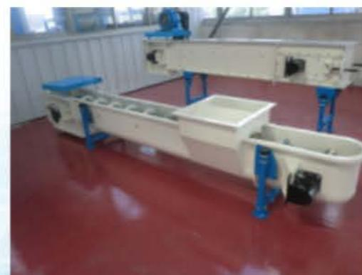
TGSS系列埋刮板输送机主要适用于港口、码头、粮库、饲料、油脂、面粉、食品、果蔬、酒精、酿造、化工等行业水平输送各类散装物料。该设备结构简单，体积小、密封性能好，结构合理，平滑的轨道和具有自润滑作用的刮板，确保运转平稳，有效地降低了噪音及物料的破损率，同时延长了整机的使用寿命。本机具有电耗省、易操作维修等特点，并配有防堵，防断链及报警等装置，提高了设备使用可靠性。机尾可配置螺旋杆装进装置，满足各类输送要求，还可灵活实现多点进料、多点出料。
