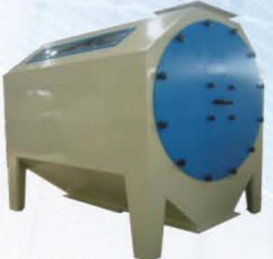
TCQY系列圆筒初清筛具有产量高，动力消耗少，结构简单，占地面积少，易于安装维修等特点。可广泛用于面粉厂、饲料厂、粮食立筒库及其它行业的原料接收部分。它是利用旋转的筒形筛面自行筛选的一种清理设备，适用于清除粮食中的大杂和轻杂，如稻草、麦秆、麻绳、纸片、土块、玉米叶、玉米棒等杂物，避免杂物引起机器设备发生故障或损坏。还可根据物料性质选配适宜的筛孔，就能达到分离要求和效果。主要有筛筒传动机构，进料装置、除尘装置、筛面清理机构等部分组成
